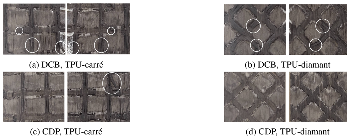
FIG. 6. – Détails des surfaces de rupture en DCB et CDP pour les inserts TPU (voir la zone concernée en Figure 5)
