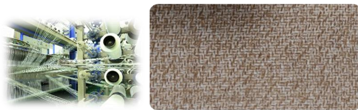
Fig. 8. Photo d'un métier à tisser (gauche) et d'une peau TP/tissu de fibres naturelles (droite) / Porcher industries
