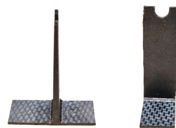
FIG. 4. – 20 mm-large joint en T chanfreiné après la découpe
