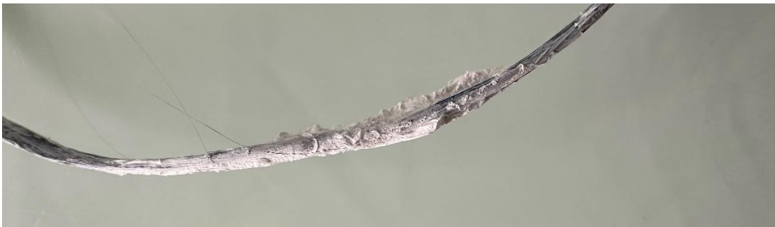
Figure 3. Preuve de concept d'une tpe thermoplastique à partir de PET recyclé avec un renfort fibreux en carbone
