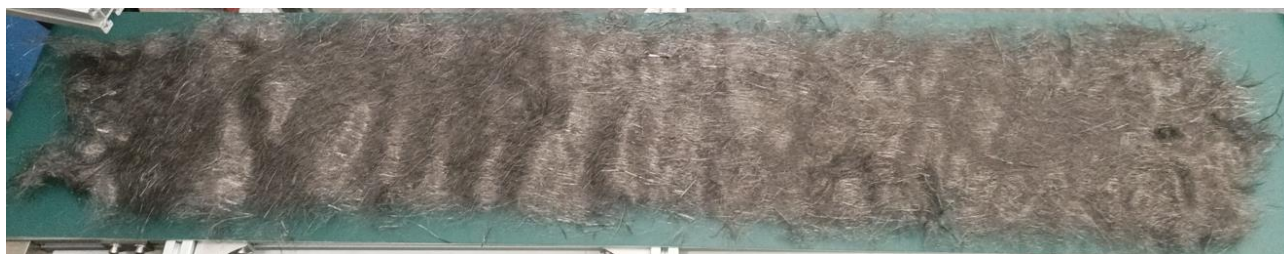
Fig. 2. Photo d'un voile 100% fibres de carbone ensimées issues de chutes de lisière (basse vitesse, 1 passage)
