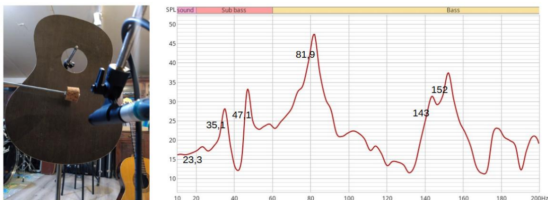
Figure 4 : Mesure acoustique des fréquences propres de la table d'harmonie non barrée. A gauche : mailloche d'impact à tête de liège et microphone en champ proche. A droite : module de la transformée de Fourier de la pression rayonnée enregistrée par le micro.
