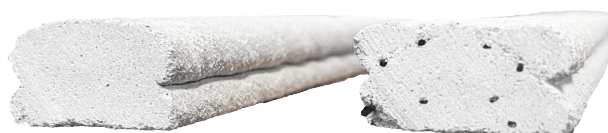
FIG. 3. – Deux couches imprimées. A gauche sans fibre, à droite avec 4 fibres par couche.
