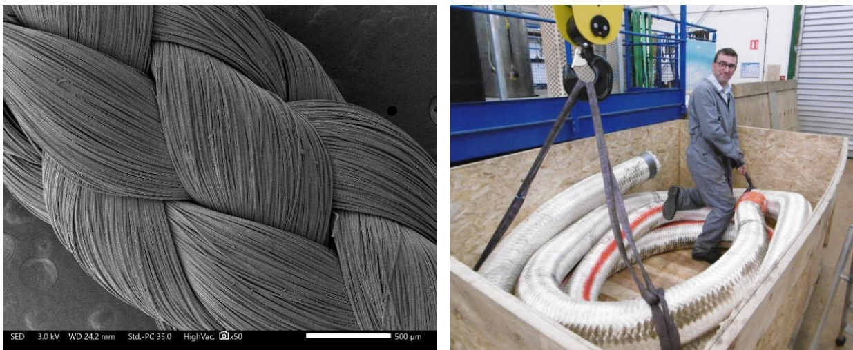
Fig. 2. Gamme des échelles des cordages marins : de la tresse de diamètre 2mm, (photo MEB à gauche), aux lignes d'ancrage de centaines de mm (à droite).
