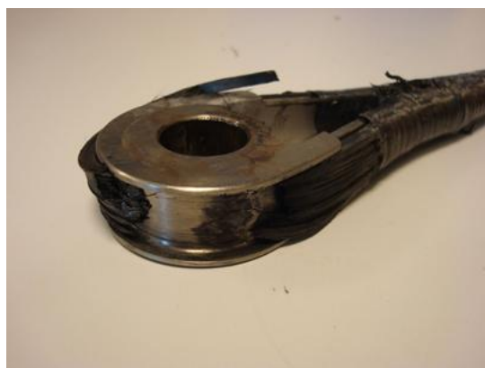
Fig. 7. Echantillon de gréement de bateaux de course en composite carbone unidirectionnel imprégné, après essai cyclique ; rupture dans la terminaison.
