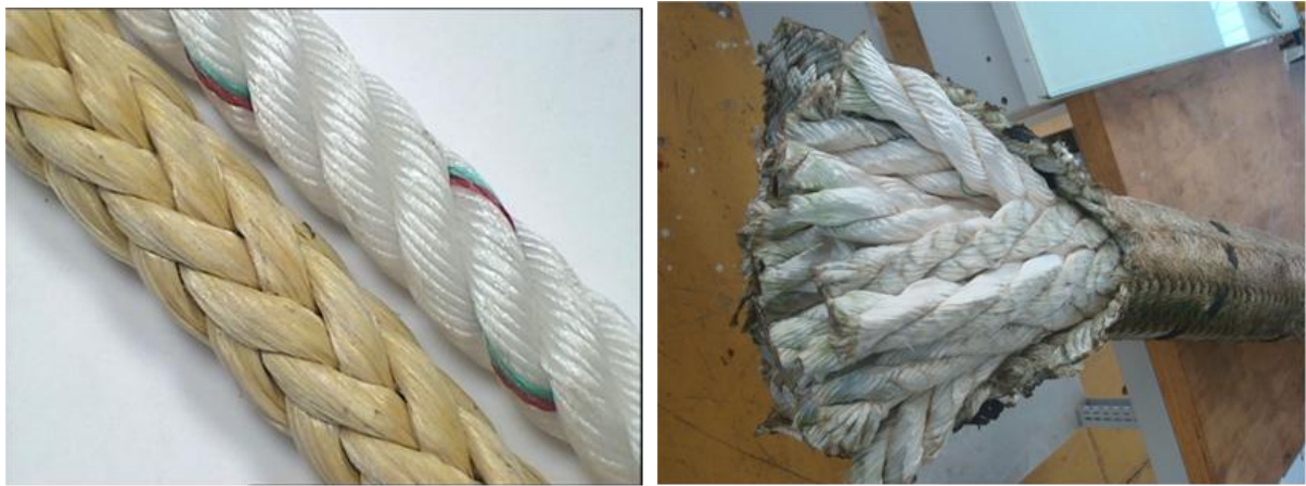
Fig. 5. Deux constructions tressées et toronnées (à gauche) et combinées dans un cordage marin de gros diamètre, 160mm (à droite), cœurs toronnés dans une gaine tressée (construction « parallel strand »).
